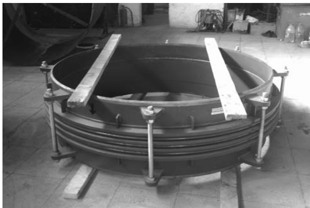
Figura 2. Compensador de dilatación
