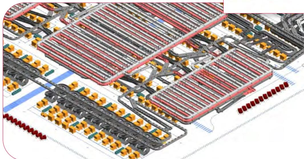
Sistema automatizado de tratamiento de equipajes (Baggage Handling System). Aeropuerto de Doha. Proyecto AI4662
