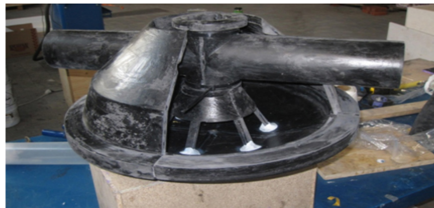
Modelo a escala 1:15 de la obra de toma ejecutado con resinas cargadas con metales
