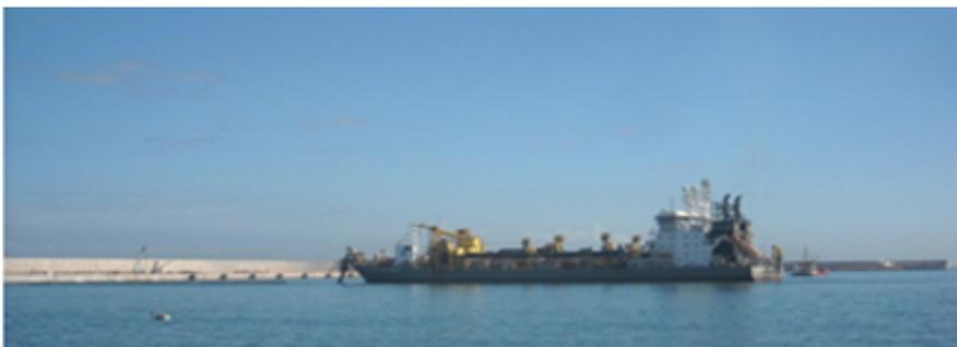
*Dragada vertiendo por tubería material procedente de dragado.*
